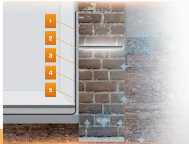
Nach Ausführung der horizontalen Abdichtung wird der Untergrund mit Rajasil SPB (Spritzbewurf) und Rajasil SPP (Sperrputz) für die Kellerinnenabdichtung vorbereitet, die mit Rajasil DS FLEX (Dichtungsschlämme flexibel) erfolgt. Nach Aufbringen einer abschließenden Putzschicht mit Rajasil SP4 wird der Keller hochwertig nutzbar.
